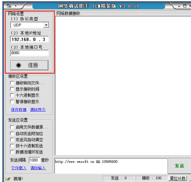
这时网络数据接收窗口会显示 FPGA 发给 PC 的以太网数据包"Hello ALINX HEIJIN"目标主机的 IP 地址需要和 FPGA 程序中的 IP 地址一致,目标端口号也需要和 FPGA 程序的一致(8080)。如下图网络显示:
