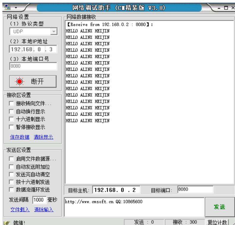
第五步:再在网络调试助手的发送窗口发送一大串字符,在网络的数据接收窗口我们可以看到从 FPGA 返回的数据也变成刚发送的字符串。
